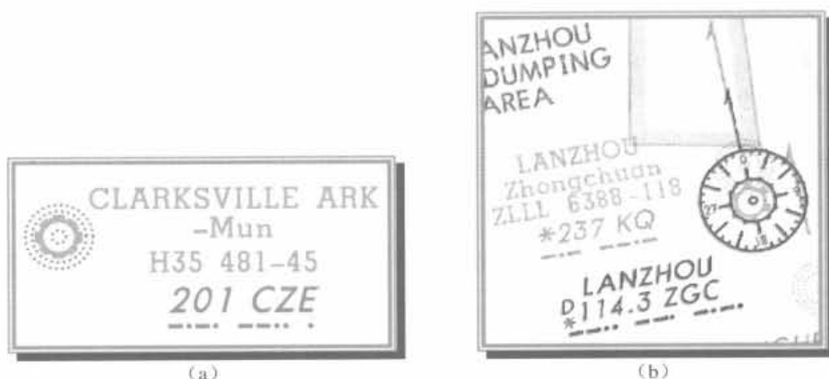
图 2.43 位于机场的导航设施
