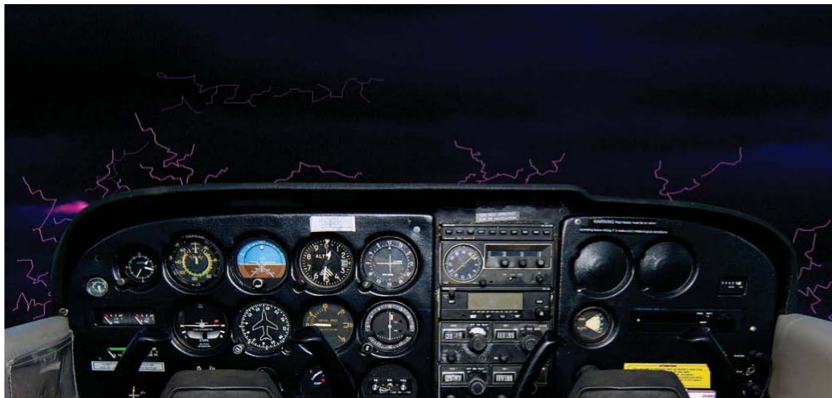
图 12-1 “圣艾尔莫之火现象（一种放电效应）”并无太大危害。但它能影响通讯和导航无线电，尤其影响 ADF 使用的较小频率。
