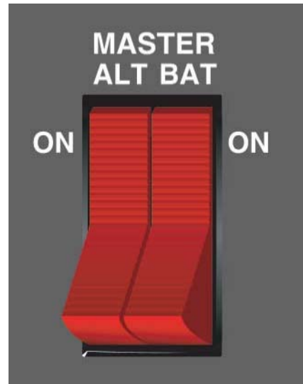
图 12-5 许多飞机上安装的双摇臂式电门。
