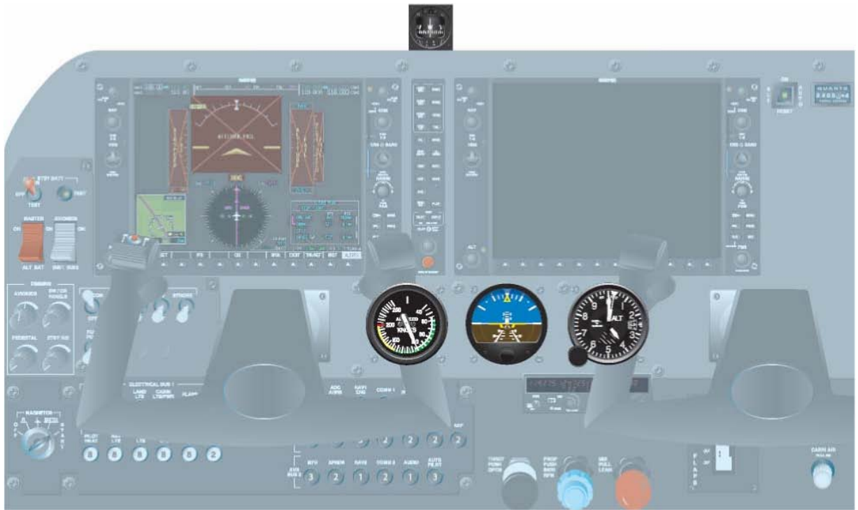
图 12-7 在安装了电子飞行仪表的飞机上，飞行员可以使用的紧急仪表。
