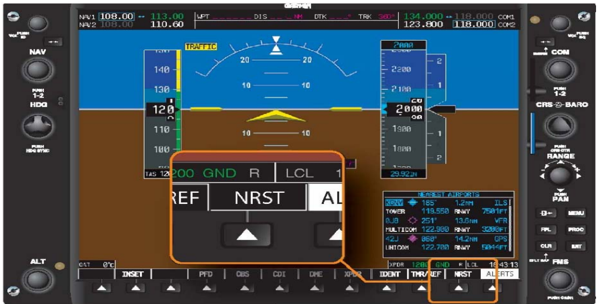
图 12-9 在 PFD 上显示的默认软键菜单中包括一个“NRST（最近机场）”软键。按压该键调出文本框显示最近的 25 个机场信息。
