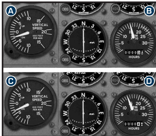
[圖 6-4] A 與 B 分別為動力稍微增加時的垂直速度錶 (VSI) 與引擎轉速錶 (tachometer)。C 與 D 則分別為這兩組儀錶在動力稍微降低時的顯示情形。
