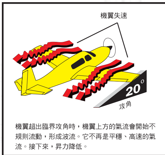
[圖8-2] 失速與未失速機翼的對照
