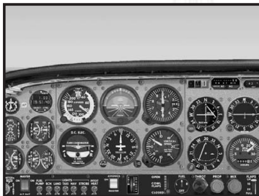
圖3-4顯示飛機如何以85節空速、每分鐘500英尺速度爬升。
